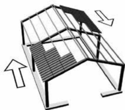
Fig. 11 : Ronddekken met golfplaten
