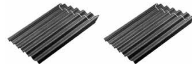
Fig. 16 : Plaats van de dichtingen bij het profiel ECOLOR : onderbroken geplaatst
